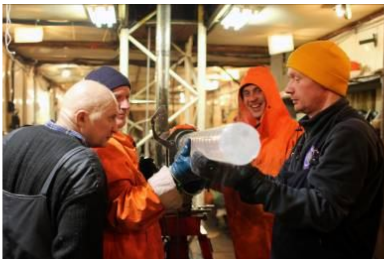
Рис. 1. Станция Восток, январь 2013 г.: извлечение ледяного керна длиной более 2 м из бурового снаряда.
