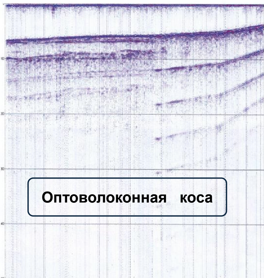
Разрез участка акватории Кольского залива, полученный с помощью макета буксируемой волоконно-оптической косы
