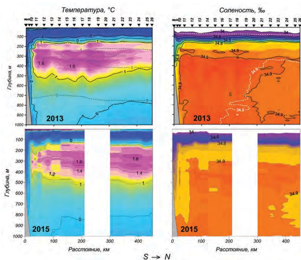
Рис. 3.1.7. Распределение значений температуры и солености воды на разрезе вдоль меридиана 126° в.д., выполненном экспедицией АВЛАП/NAVOS в сентябре 2013 и 2015 гг. Пунктирной линией на верхних рисунках показаны средние климатические значения температуры и солености воды. Положение разреза указано на рис. 3.1.1 белым прямоугольником.
