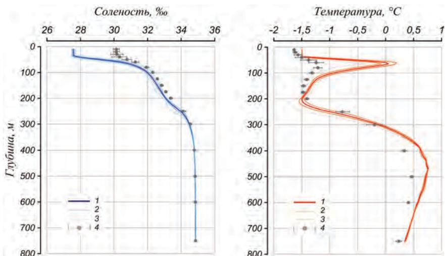
Рис. 3.1.3. Вертикальное распределение солёности и температуры воды в Канадской глубоководной котловине в апреле — июне 2015 г. по результатам измерений профилографа ГТР-80.
