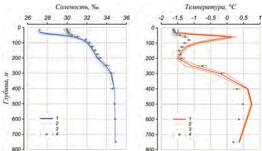
Рис. 3.1.2. Вертикальное распределение солёности и температуры воды в Канадской глубоководной котловине в январе — марте 2015 г. по результатам измерений профилографа ГТР-80.
