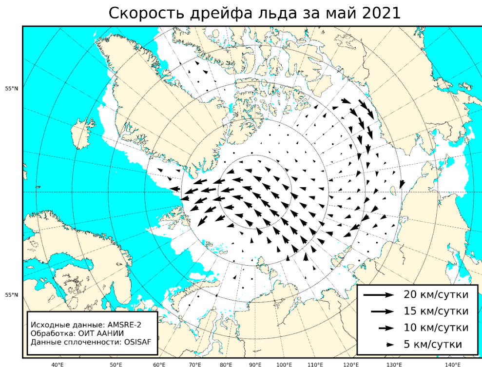
Рис. 2.1.8 Поле скорости фактического дрейфа морского льда в мае 2021 г., восстановленное на основе корреляционного анализа спутниковых изображений льда в микроволновом диапазоне
