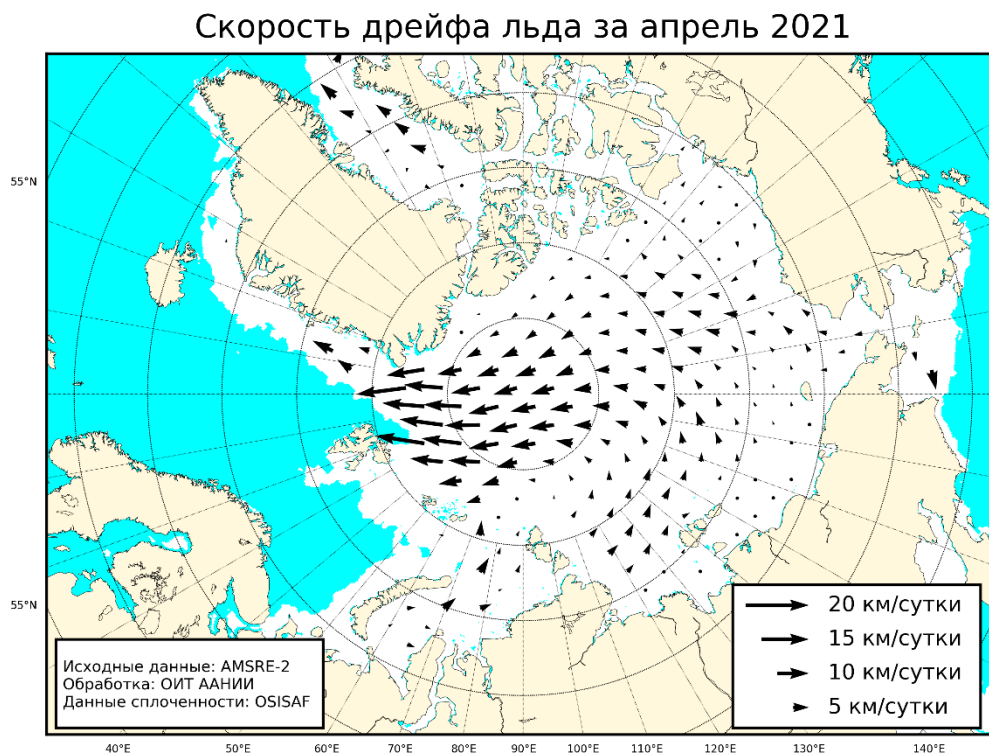
Рис. 2.1.5 Поле скорости фактического дрейфа морского льда в апреле 2021 г., восстановленное на основе корреляционного анализа спутниковых изображений льда в микроволновом диапазоне
