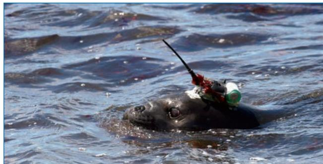
Недавно появившаяся модификация приборов позволяет записывать данные в непрерывном режиме и получать весь CTD-архив за последние несколько месяцев с частотой дискретизации 0,5 Гц (раз в две секунды).
