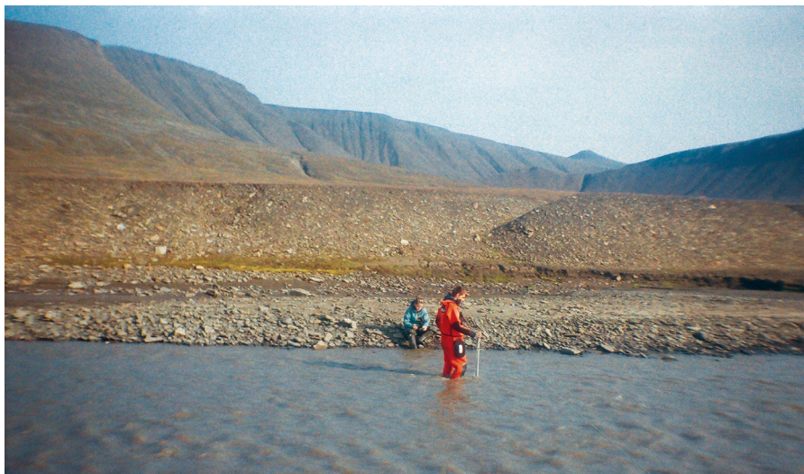
Рис. 2. Измерение расхода воды реки Грён-фьорд 30.07.2018 12:40
