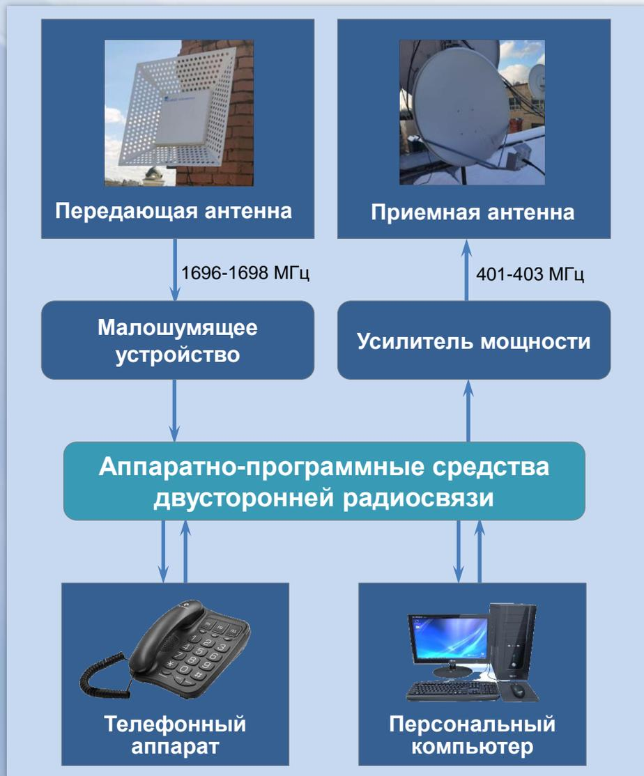
**Впервые в мире** на базе частотного ресурса метеорологических спутников разработана система двусторонней радиосвязи, использующая отечественные технические средства и российские геостационарные (Электро-Л, Луч-5) и высокоэллиптические (Арктика-М) спутники. США, ЕС и Япония планируют создание подобных средств связи не ранее 2028 года.
