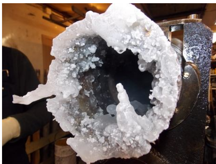
Коронка бурового снаряда с намёрзшей озёрной водой
